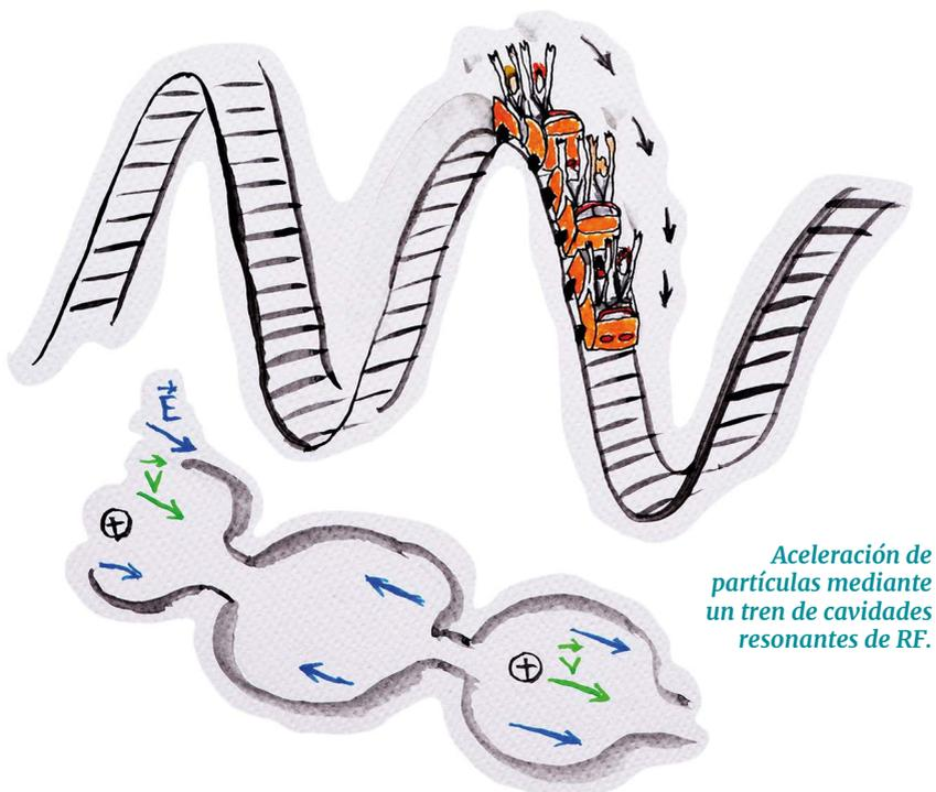
*Aceleración de partículas mediante un tren de cavidades resonantes de RF.*
